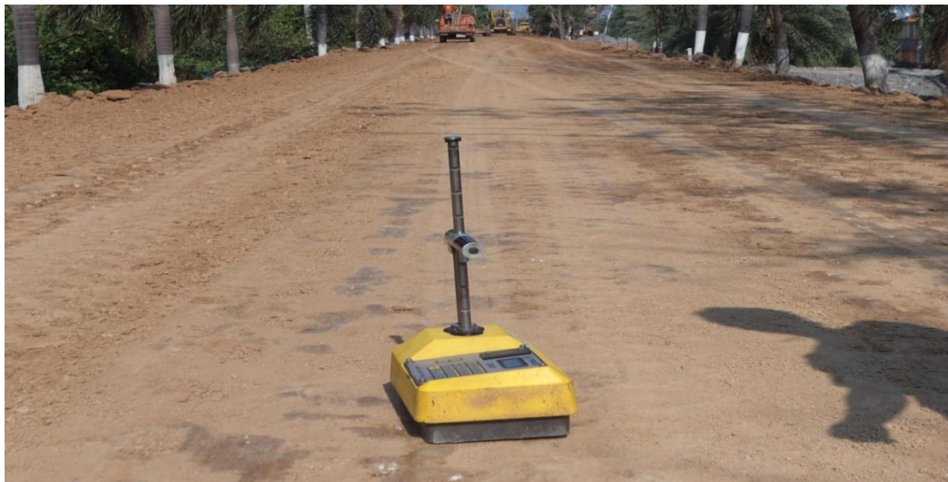
รูปที่ 3.3 การทดสอบความแน่นในสนาม
